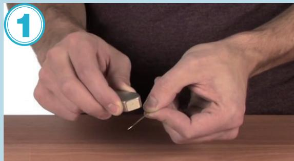
1 确认磁铁的南北极之后，用磁铁的“北极”端摩擦缝衣针尖端。注意：摩擦时要一手握住缝衣针的中间部位，另一手拿着磁铁，从缝衣针的中部开始，自上而下地进行摩擦。从上到下摩擦完一遍，算作1次，共摩擦50次。
